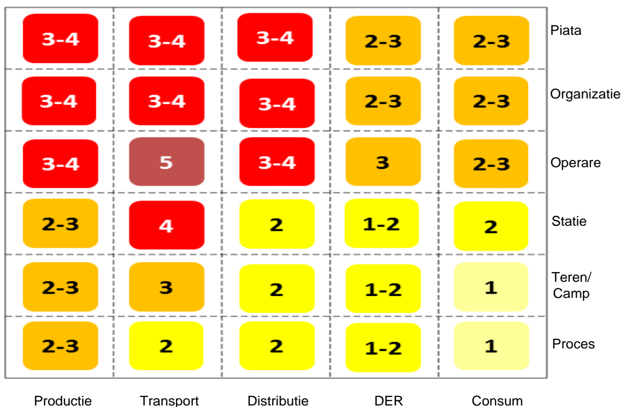
Figura 2 – Maparea nivelurilor de securitate pe arhitectura Smart Grid
